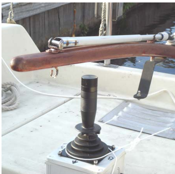
Abb. 5-2: Position des ComfoDrive-Joysticks auf einem Boot mit Pinnensteuerung
